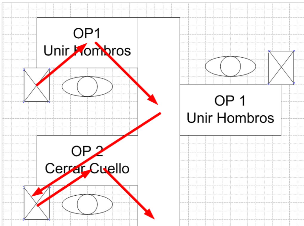
Figura 10 Secuencia del flujo entre puestos de trabajo
